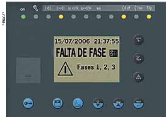
Sinalização local no painel frontal do Sepam.
